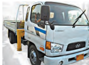
■ HYUNDAI HD 78, г.в. 2013, турбодизель, 140 л.с., г/п борта 4 т, дл. 5 м, кран Soosan 334, г/п 3,2 т, вылет стрелы 13 м, 4 аутригера, горный тормоз, кондиц., ц. 2 млн 220 т.р., обмен. Т. 8-912-280-57-00.
